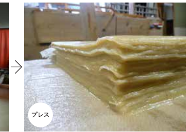
プレス 漉いた紙を重ねて紙床を作り、一晩寝かせた後プレスにかけて水分を絞る Stack upon each other and leave it stand overnight and press it
