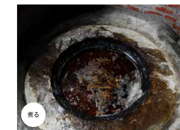
煮る 消石灰で原料を煮る Boiling with slacked lime
