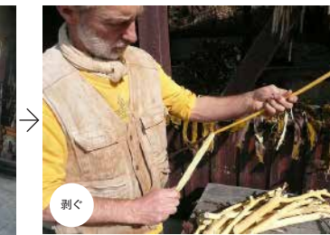
剥ぐ 2-3時間蒸した原料の木芯から皮を剥がす Peeling off the bark after two or three hours steaming
