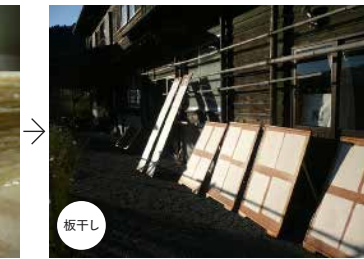
板干し 1枚ずつ干し板にはりつけて天日で乾燥させる。 Every single sheet is dried on a wooden board outdoors in the sun
