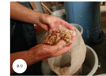
ネリ トロロアオイの根を叩いて粘り(ネリ)を出す Crush the tororoaoi roots to make a viscous liquid: neri
